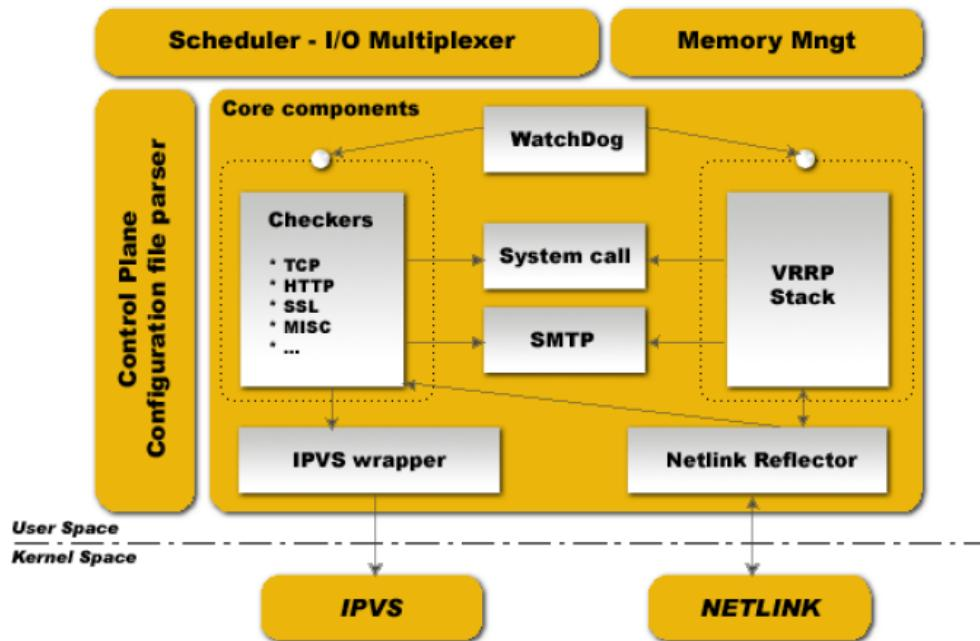
**core** keepalived的核心程序，比如全局配置的解析，进程启动等等；
